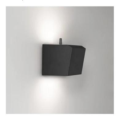
Lampada da parete con sorgente luminosa a LED configurabile mediante switch interno nelle seguenti modalità: luce indiretta / luce diretta / luce diretta e indiretta. La lampada può essere controllata da remoto se collegata ad una rete Wi-Fi con frequenza 2,4 GHz. Il prodotto funziona tramite la app Zafferano Lighting, ma è compatibile anche con Tuya Smart, Alexa e Google Home.
