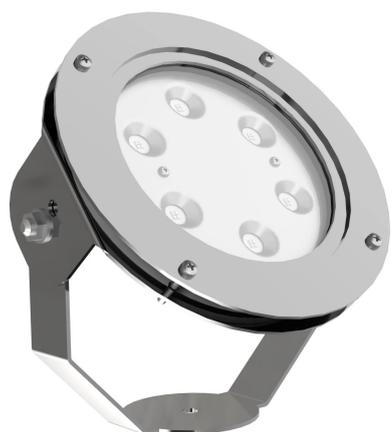
Lampada per fontana a LED con colore variabile RGBW, ideale per installazioni di medie dimensioni. Controllate con segnale DMX 512. Disponibile con varie ottiche per illuminare vasche o getti di forme diverse. La staffa orientabile permette l'installazione in qualsiasi posizione.
