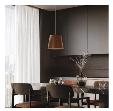
Lampada a sospensione con struttura in alluminio verniciato bianco opaco, corten o grigio scuro, e diffusore in policarbonato trasparente. La sorgente luminosa è a LED, dimmerabile. La lampada è adatta esclusivamente ad uso interno.
